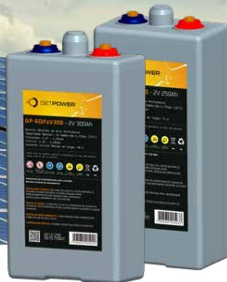
As Baterias Chumbo Ácidas Estacionárias Reguladas por Válvulas (VRLA-Valve Regulated Lead Acid), da Série **GP-OPzV** possuem Tecnologia de Eletrólito Gel com Placas Positivas Tubulares, o Separador é um polímero microporoso o qual apresenta alta porosidade, baixa resistência elétrica, além de excelente resistência mecânica e química. Suas características construtivas contribuem para uma excelente performance em aplicações de média e longa intensidade de descarga.
